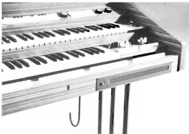
Fig. 25 Interruttori per registri, tiranti speciali, tasti a pressione, tastiera a rulli per il glissando d'arpe e rullo a ginocchio per glissando dei formanti (visti dall'alto al basso)
